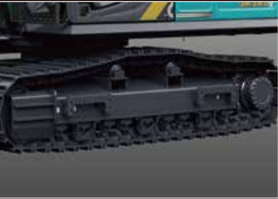
增强型履带校正器(单侧3个) 防止在恶劣的矿山现场的链轨脱落。
