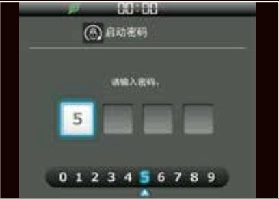
发动机启动密码设置功能 可设置发动机启动密码，增强安全性。首次需要在代销商处进行密码设置。
