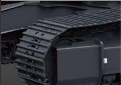
加厚履带板 采用厚钢板强化型HD履带板，更好适应粗糙岩石的矿山工况。
