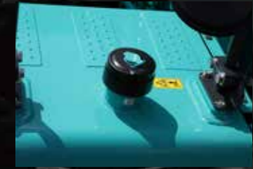
燃油箱防尘盖 加油口为橡胶覆盖型，采用灰尘难以混入的防尘盖。
