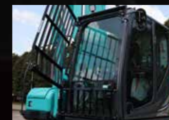
带防爆膜玻璃 采用带防爆膜的玻璃，即使玻璃破损也不会有碎片飞溅。
