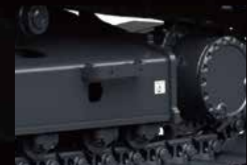
下车架脚踏 在履带框架侧加装了金属解体机专用的脚踏。
