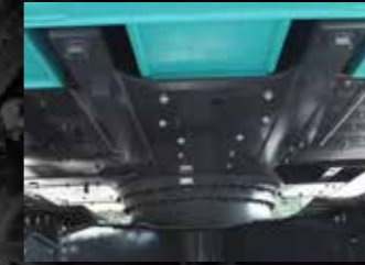
上部车体下护板 配备加强型护板，防止金属片侵入损伤部件。
