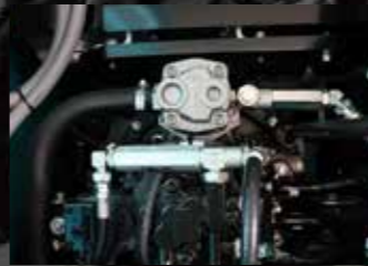
神钢特有解体机液压系统 P4泵与专业操控系统相结合，可实现对液压剪的精确控制，提高灵敏性，复合动作更顺畅。
