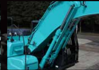
大臂油缸活塞杆保护装置 保护油缸活塞杆免于接触拆解物，避免受飞溅的金属片损伤。
